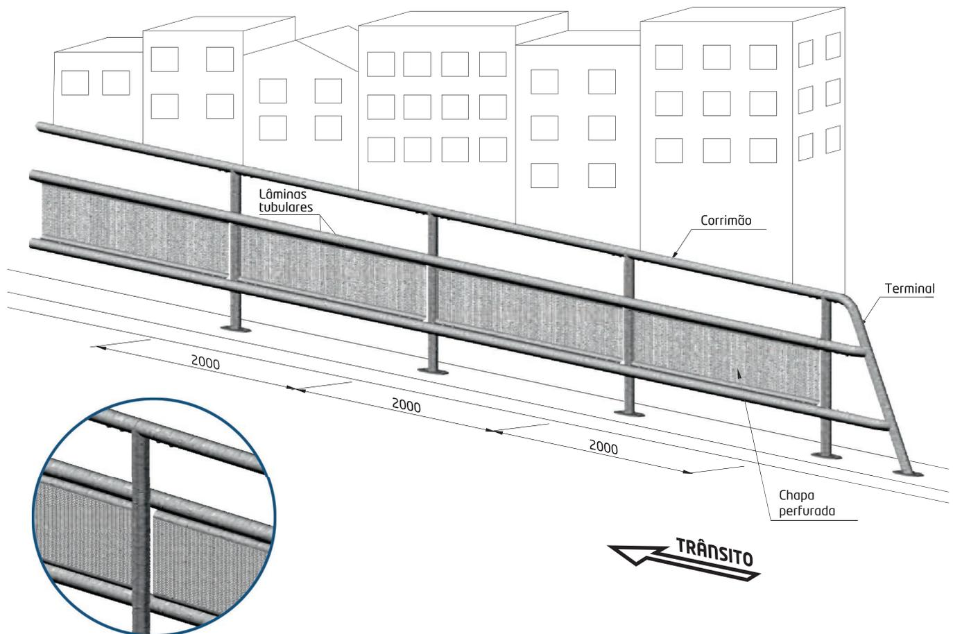
Sistema de alta capacidade de contenção de veículos, especialmente desenvolvido para ser instalado em ambiente urbano. É composto basicamente por três lâminas tubulares de secção circular, suportada por postes tubulares dispostos regularmente a cada 2m. Os postes são fixados por sua base no pavimento, mediante um sistema de ancoragem química do tipo haste rosqueada (chumbador) + resina. Entre a lâmina intermediária e inferior se dispõe uma chapa perfurada.
