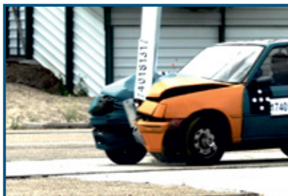
Poste 12m Carro de 900 kg, a 100 km/h
