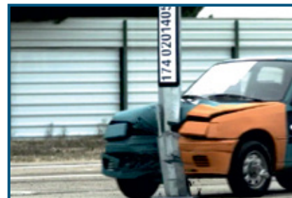
Poste 6m Carro de 900 kg, a 100 km/h
