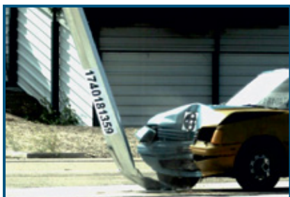
Poste 12m Carro de 900 kg, a 35 km/h
