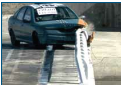
Ensaio TB 31 Carro de 1.500 kg, a 80 km/h e 20°
