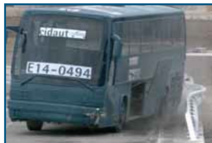
Ensaio TB 50 Ônibus de 13.000 kg, a 50 km/h e 20°
