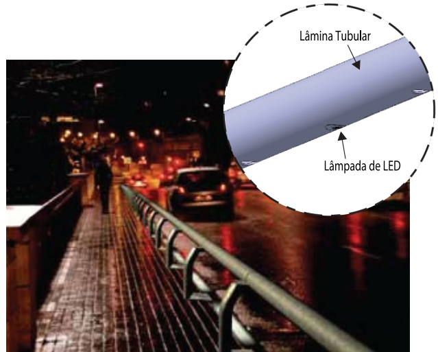
Opcionalmente, a barreira pode incorporar um sistema de iluminação LED
