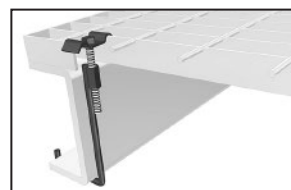
Grampo tipo 1 ou "J" Para vigas de 4", 6", 8" e 10".
