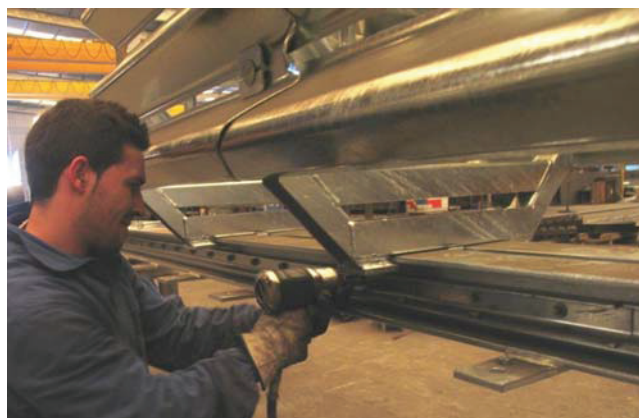
Colocação de perfis absorvedores
