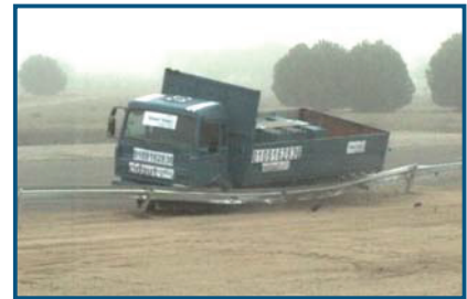
Ensaio TB 42 Caminhão 10.000 kg, a 70 km/h e 15°
