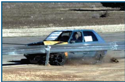
Ensaio TB 11 Carro 900 kg, a 100 km/h e 20°
